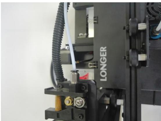
3. En raison de l'extrémité des consommables dans la buse pouvant se déformer par la chaleur, si les consommables déformés sont directement sortis, ils peuvent être collés au joint pneumatique ou au fin de course pour la détection des dommages. (L'interrupteur de fin de course pour la détection de matériaux cassés est unique. Voir ci-joint).
