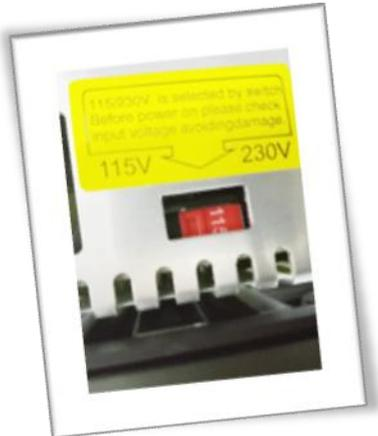
Afin d'éviter des dommages, veuillez vérifier que votre tension d'accès dans votre commande de boîtier peut être ajusté de 110V si indiqué et soyez sûr de confirmer avant de le mettre sous tension.
