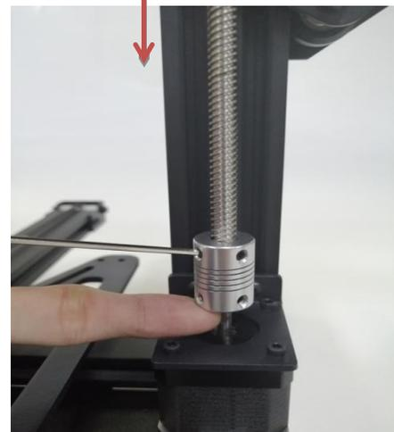
Ajustez les deux vis en effectuant le mouvement. Les deux vis ne peuvent pas être serrés trop fermement. Tourner le couplage manuel pour ajuster le mouvement de la vis.
