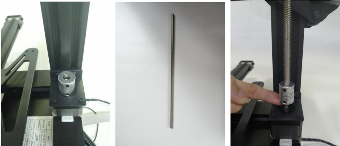
Laissez la vis mère s'encliqueter dans l'arbre du moteur couplé afin qu'il soit aligné avec la vis mère. Serrer le fil supérieur
