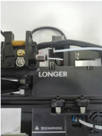
1. Avant de renvoyer le document, chauffez d'abord la buse, puis retirez les consommables dès que possible. Si vous ne pouvez pas le pomper, vous pouvez le ré-alimenter avec le matériau avancé et faire fondre le bloc extrudé formé à l'extrémité du consommable situé dans la buse.
